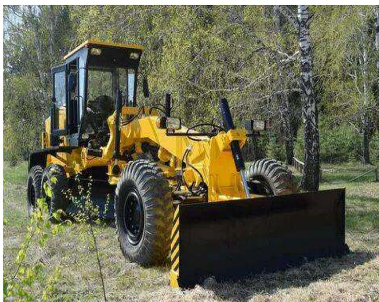
Рисунок 1. Автогрейдер ДЗ-98 прокладывает минерализованную полосу
