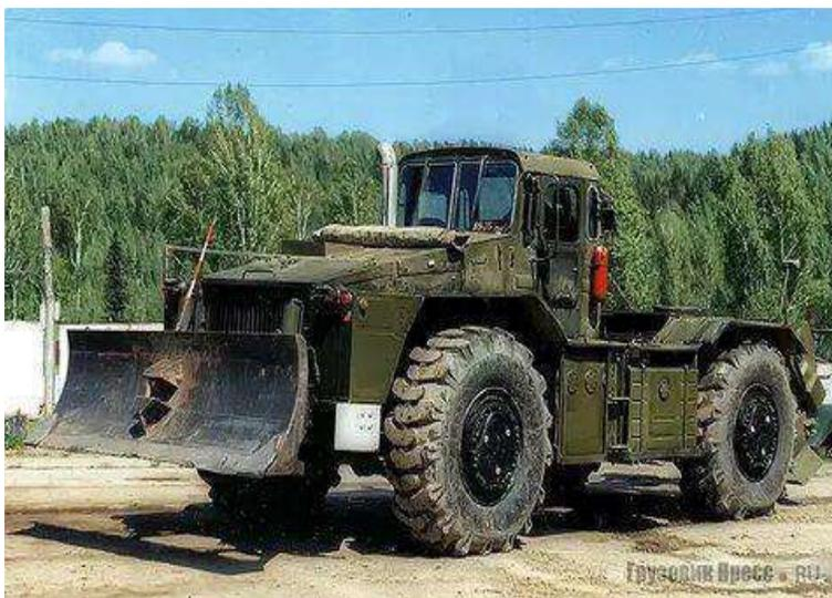
Рисунок 2. Бульдозер БКТ-рк2 готовится прокладывать опорную минерализованную полосу
