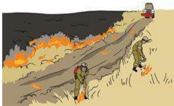
Рисунок 4. Встреча степного пожара на минерализованной полосе с тушением перебросов (без проведения отжига) при косвенно-параллельном тушении
