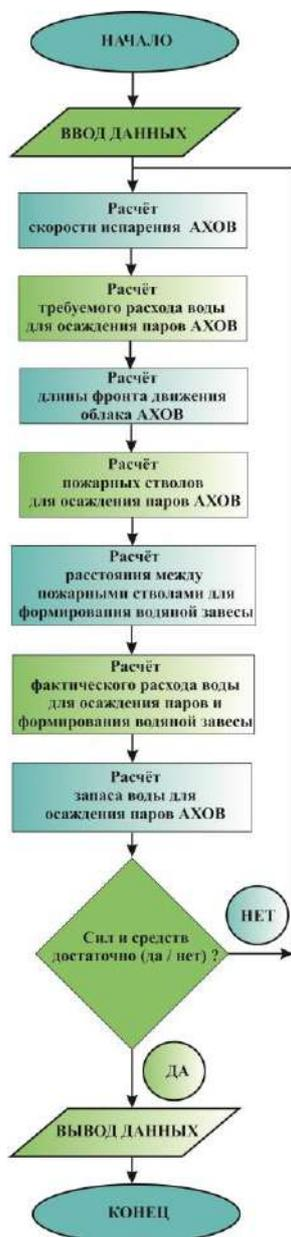
Рисунок 3. Алгоритм расчёта сил и средств пожарно-спасательных подразделений для постановки водяной завесы при осаднении аммиачно-воздушного облака
