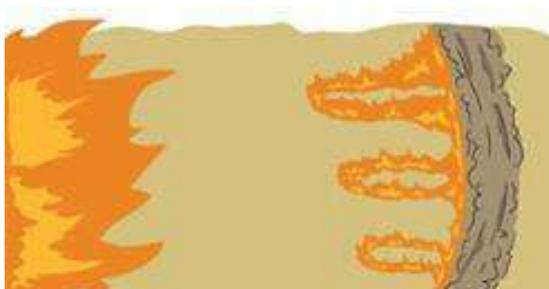
Рисунок 10. Схема отжига способом гребёнки
