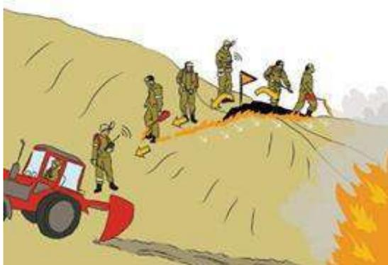
Рисунок 12. Схема тушения отжигом по перевалу от опорной (заградительной) полосы
