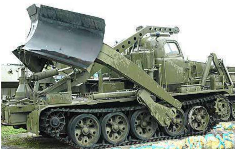
Рисунок 3. Бульдозер БАТ-М выдвигается для прокладки опорной минерализованной полосы
