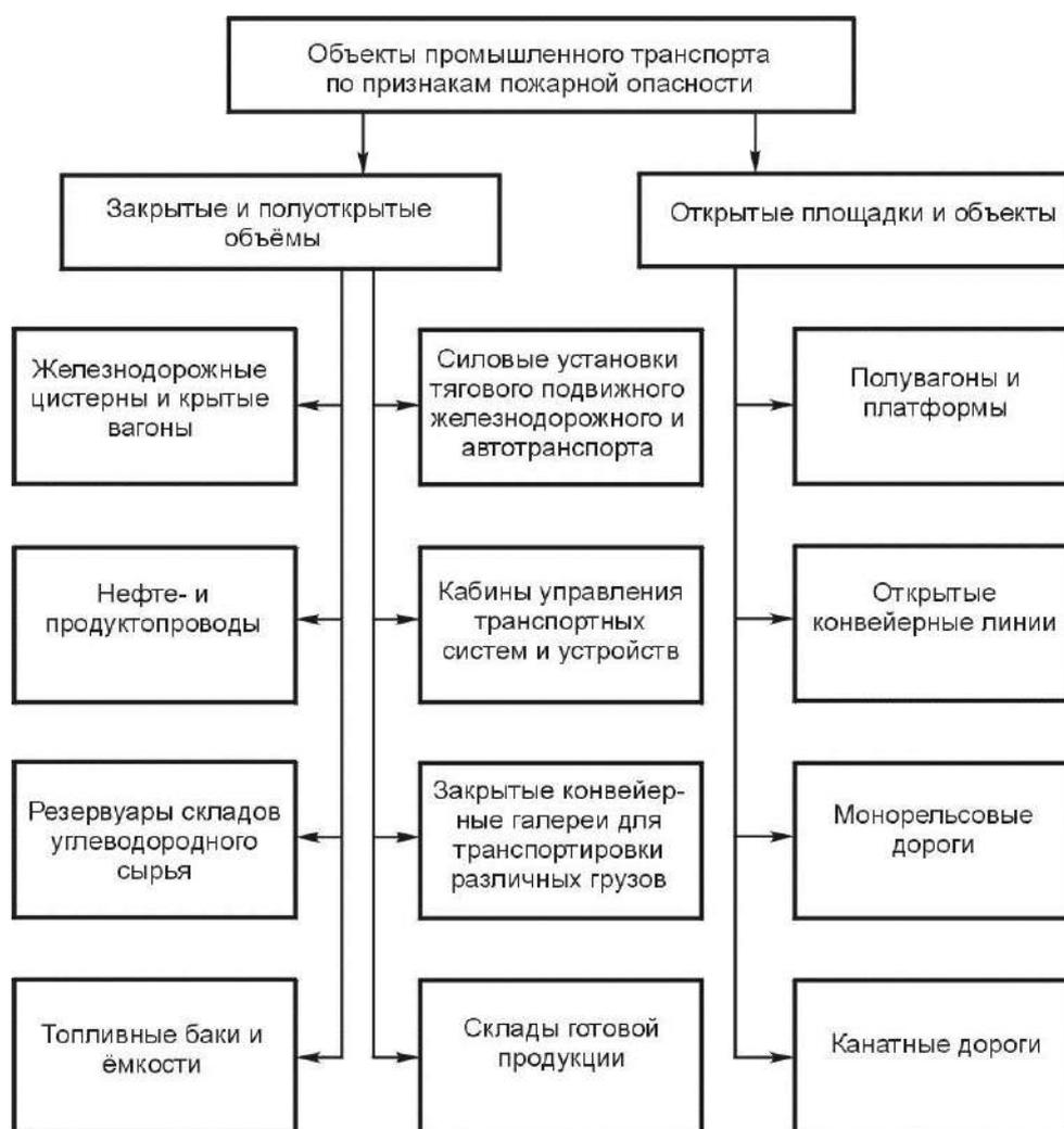
Рисунок. Структура объектов промышленного транспорта по признакам пожарной опасности
